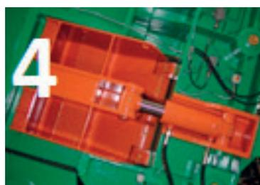
Le taglia rottami a cassa inclinata ed alimentazione continua TR sono dotate di una cesoia provvista al suo ingresso di un pressore verticale (3) e due coperchi laterali oscillanti (4). Il rottame da cesoiare viene caricato nella cassa di alimentazione, fissata anteriormente alla struttura della cesoia, composta di una tramoggia chiusa ai lati, con la parte superiore aperta ed il fondo inclinato di 30° e oscillante (1) (5).
