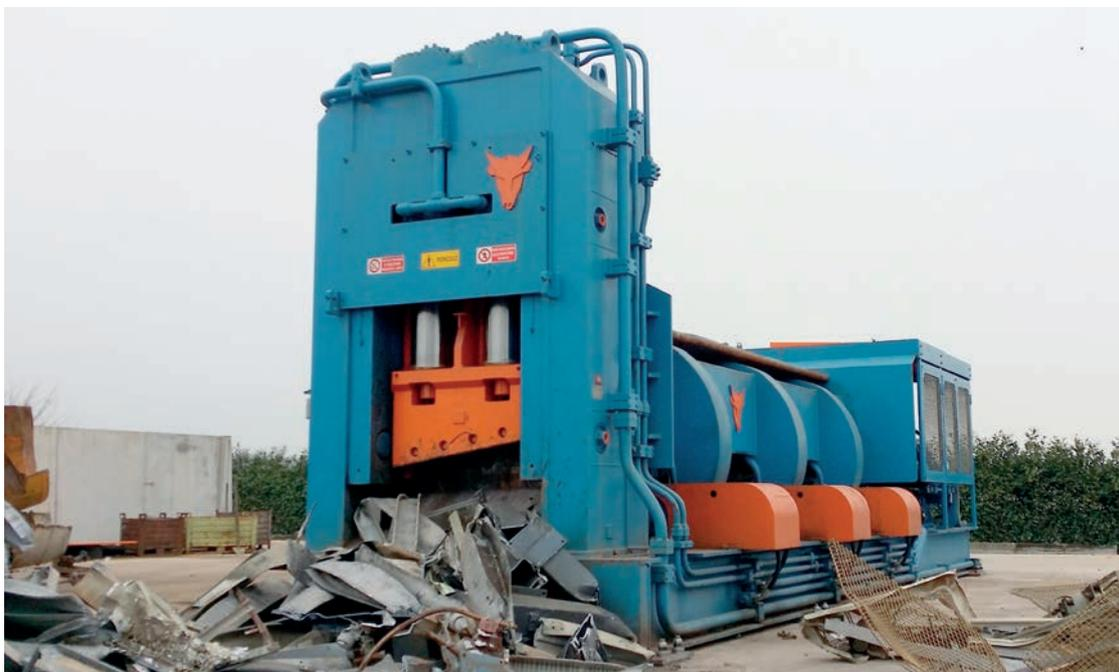
L'industria del rottame sta subendo un radicale cambiamento, al quale le tecnologie dedicate si devono adeguare. Quindi basta fondazioni, strutture accessorie e mal di testa burocratici, la pressa&cesoia deve entrare nel cantiere di rottame senza disturbare la produzione, essere appoggiata sul pavimento e funzionare a pochi giorni dalla consegna. Quando avrà finito la sua vita utile dovrà essere smantellata rapidamente e andarsene senza lasciare ricordi della sua presenza.
