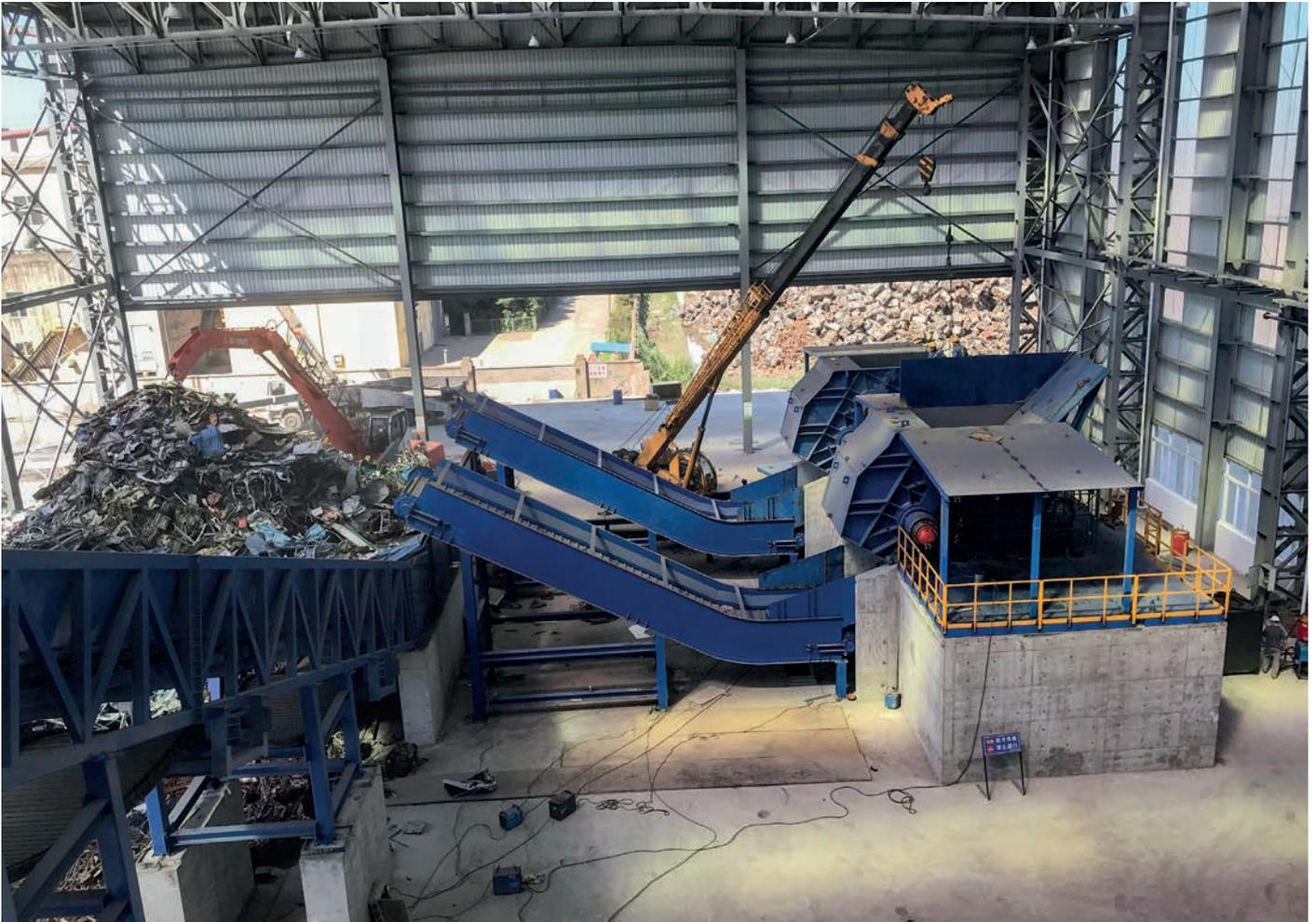
Il "redripper" BRAVO, ad alberi orizzontali controrotanti, è utilizzato a monte dei mulini a martelli negli impianti di macinazione del rottame, per frantumare in modo grossolano ed omogeneo i rottami misti, voluminosi e le autovetture da demolire. È in particolare utilizzato per pre-frantumare i pacchi di carrozzerie, di rottame leggero e raccolta, così da agevolare l'alimentazione e rendere uniforme la successiva operazione di frantumazione al mulino.
