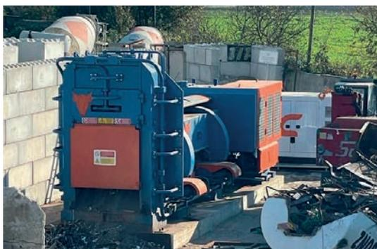
Una macchina che può fare di tutto, che produce pacchi da rottame leggero, auto bonificate e raccolta da inviare ai frantoi e che può cesoiare rottame pesante e da demolizione "pronto al forno" con costi di esercizio contenuti:
