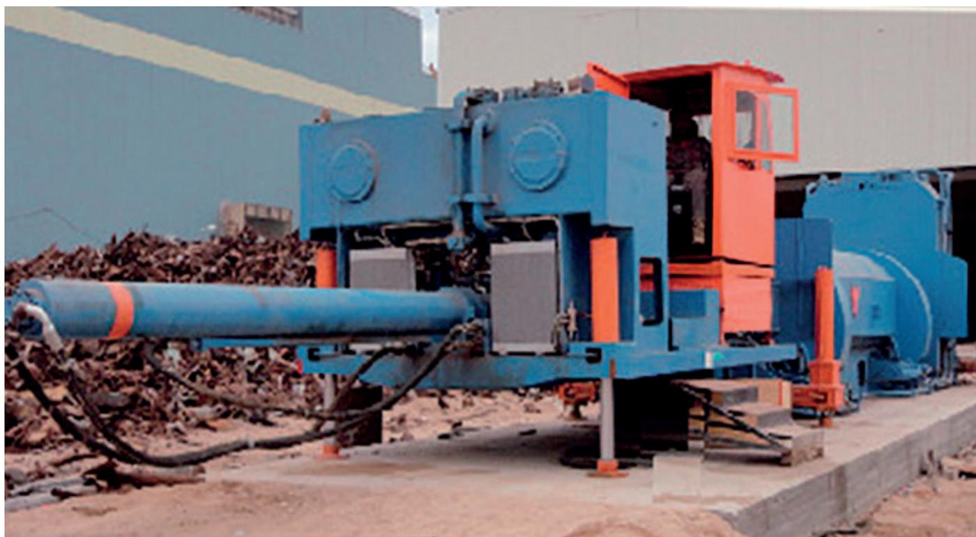
Le presse&cesoie “ELLE” trasportabili (loading-unloading) sono adatte per gli utilizzatori che necessitano di frequenti spostamenti o le utilizzano per noleggiarle a terzi. Lavorano sia appoggiate a terra che sul mezzo di trasporto, sono rapide e semplici da posizionare e mettere in funzione.
