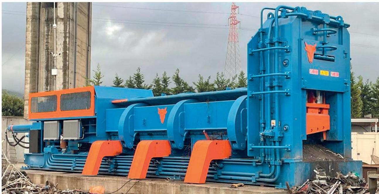
La pressa&cesoia "COMPACT" è una macchina versatile, adatta a processare le più diverse tipologie di rottame. La pressa&cesoia COMPACT "ONE-PIECE" ha un unico corpo monolitico su telaio autoportante, non necessita di fondazioni e di particolari permessi.
