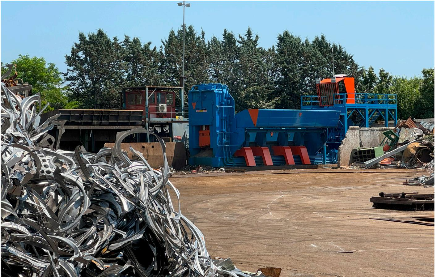
Lo scopo delle presse cesoie è semplice: tagliare il rottame in dimensioni e densità tali da ottimizzare gli spazi occupati di stoccaggio, ridurre i costi di trasporto, fornire il rottame “pronto al forno”. Difficile è fare una macchina al top della tecnica e delle tecnologie.
