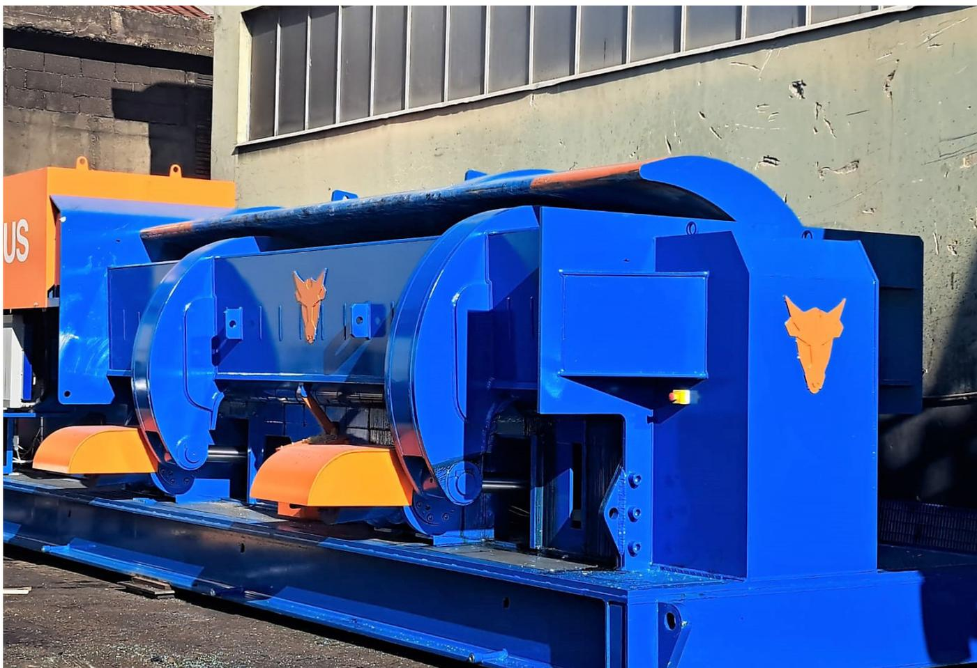
La pressa della nuova linea "KEF" è composta da un'unica struttura monolitica, non necessita di fondazioni ed è facile da installare e riposizionare.
