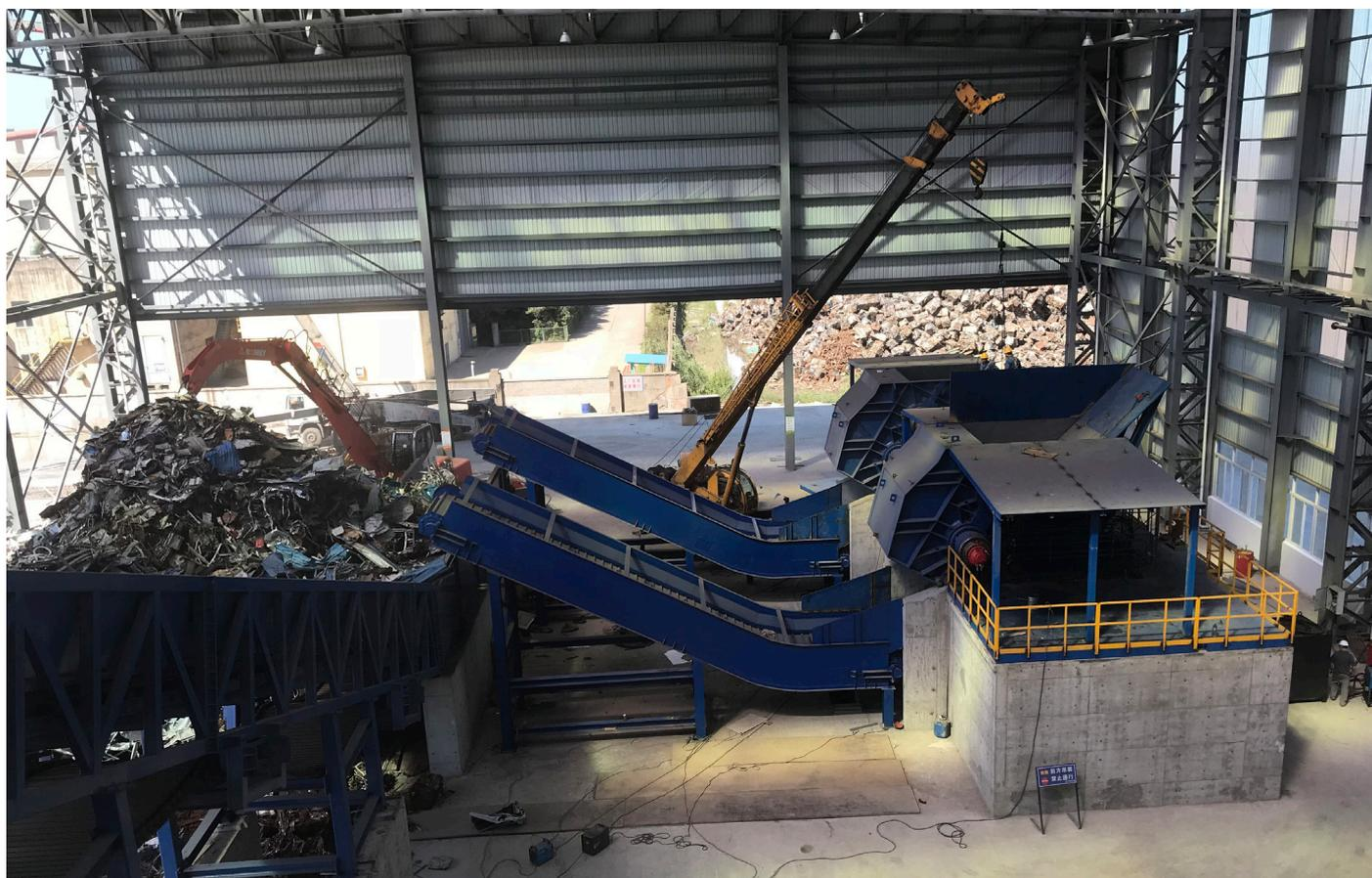
Il “redripper” BRAVO, ad alberi orizzontali controrotanti, è utilizzato a monte dei mulini a martelli negli impianti di macinazione del rottame, per frantumare in modo grossolano ed omogeneo i rottami misti, voluminosi e le autovetture da demolire. È in particolare utilizzato per pre-frantumare i pacchi di carrozzerie, di rottame leggero e raccolta, così da agevolare l'alimentazione e rendere uniforme la successiva operazione di frantumazione al mulino.
